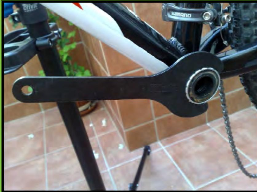
Una vez extraídas las cazoletas acordaros como iban y anotar la posición de los separadores en su caso. Si la caja es de 73 mm lleva un separador en el lado derecho, si es de 68 mm lleva dos en el derecho y uno en el izquierdo con objeto de que la caja llegue a medir unos 75,5 mm manteniendo una línea de cadena adecuada (esto en el caso de tener sistema 3x9). Aquí sigue habiendo porquería.
