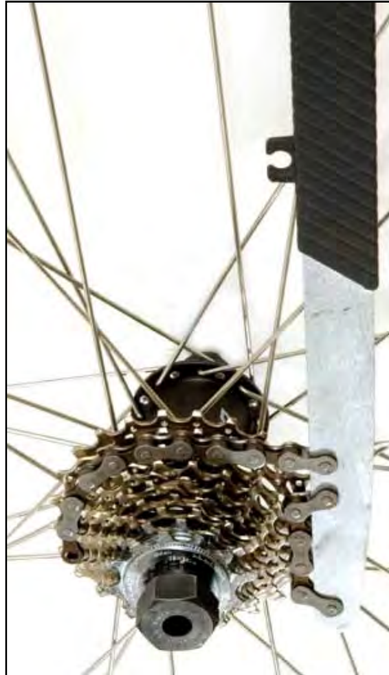
Imagen 2 Colocación de las llaves.
